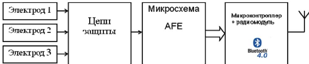
Рис. 1. Структурная схема датчика для беспроводного кардиоанализатора
