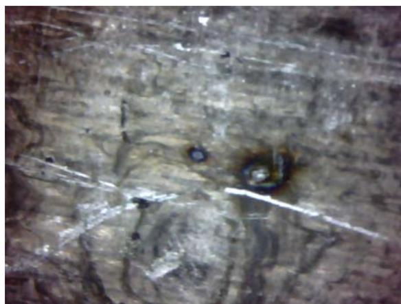
Рис. 3. Результат возникновения электрического пробоя в графитовой вставке в результате возникновения электрической дуги (нижняя сторона графитовой вставки)
