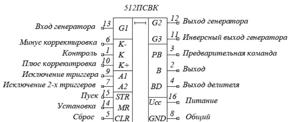
Рис. 1. Обозначение и выводы МС 512ПС8К
