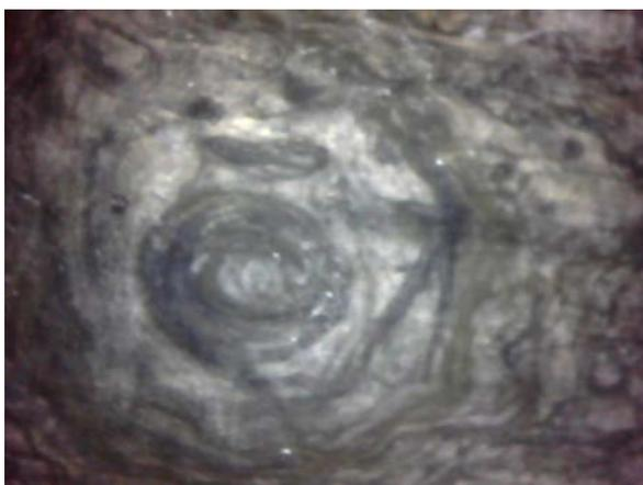
Рис. 2. Результат возникновения электрического пробоя в графитовой вставке в результате возникновения электрической дуги (верхняя сторона графитовой вставки)
