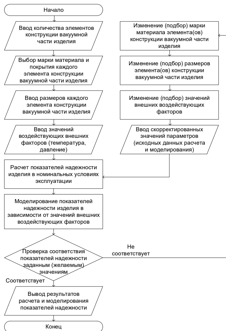
Рис. 2. Алгоритм работы СППР для анализа надежности ВКУ
