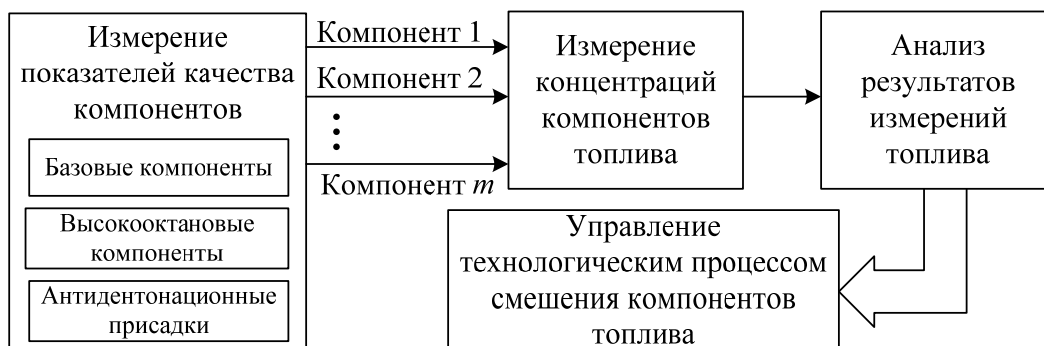
Рис. 1. Структура информационно-измерительной и управляющей системы определения состава и детонационной стойкости топлива
