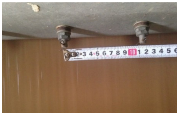
Рис. 12. Расстояние между секциями напорного ящика в сантиметрах
