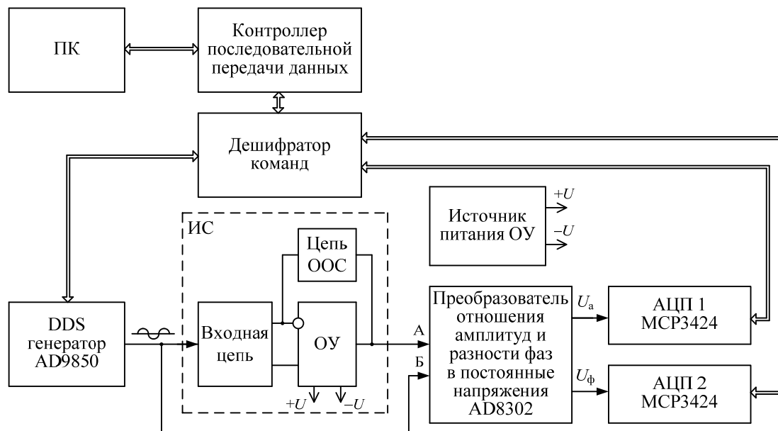
Рис. 1. Структурная схема измерителя частоты единичного усиления и запаса устойчивости ОУ по фазе
