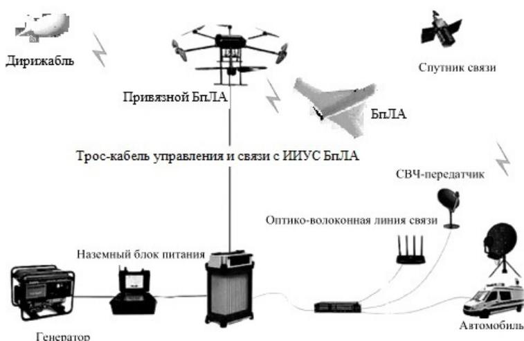
Рис. 1. Типовая схема построения моделей в телекоммуникационной сети ИУС
