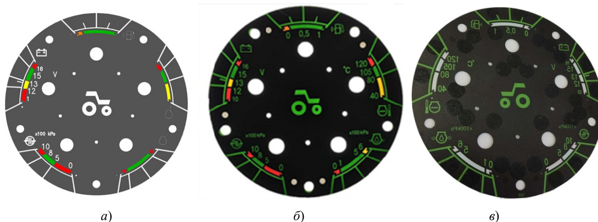
Рис. 2. Общий вид: а – пленочной приборной шкалы с лицевой стороны без подсветки (верхний слой); б – с лицевой стороны с подсветкой (нижний слой); в – приборной шкалы с обратной стороны, на которую нанесен клеевой слой в виде отдельных пятен, которые слабо видны на рисунке по причине бесцветности и прозрачности клея
