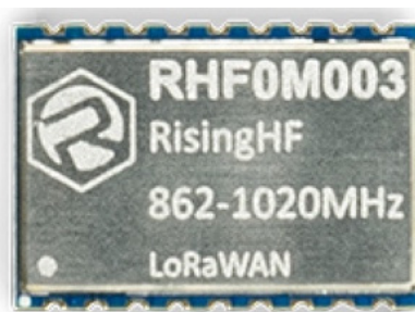
Рис. 4. Печатная плата (PCB) с модулем RisingHF с интерфейсом UART для считывания показаний с приборов учета
