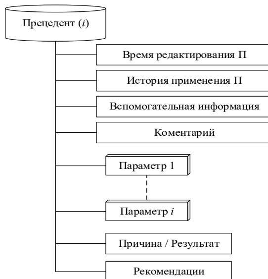
Рис. 3. Структура прецедента в базе прецедентов СППР в процессе испытаний КСр
