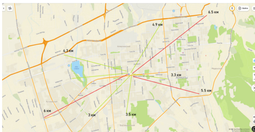
Рис. 13. Измерение силы сигнала при антенне 10 dBi
