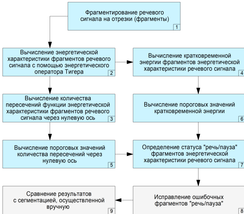
Рис. 1. Структура модернизированного способа сегментации речевых сигналов на основе энергетического анализа фрагментов речевого сигнала с помощью ТЕО и последующего анализа ZCR и STE
