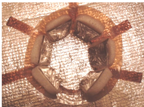
Рис. 5. Внутреннее представление «воздушных сердечников» манжеты
