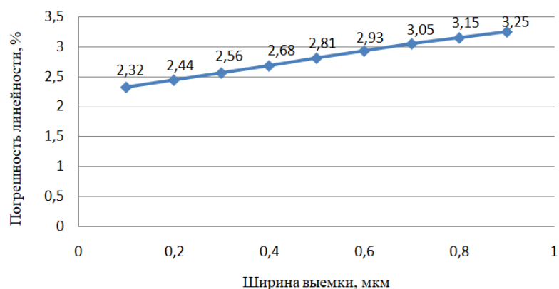
Рис. 15. Зависимость погрешности нелинейности от ширины выемки (концентратора напряжений)
