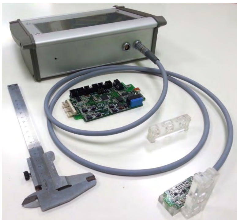
Рис. 4. Внешний вид трехволнового лазерного пульсоксиметра (в том числе показан конструктив основной платы и датчика)
