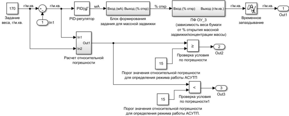
Рис. 6. Блок управления массовой задвижкой из рис. 5
