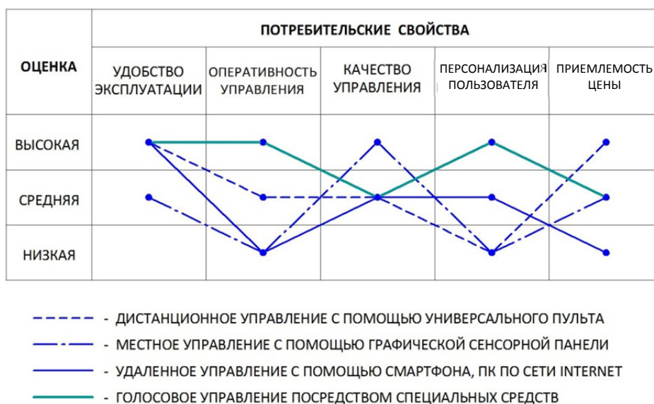
Рис. 2. Сравнительный анализ потребительских свойств видов управления СДА
