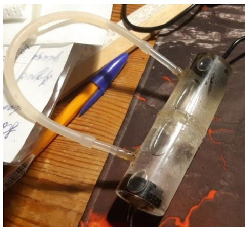
Рис. 4. Внешний вид одного УЗД блока из макета
