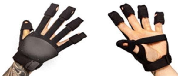
Рис. 2. Внешний вид перчатки с датчиками
