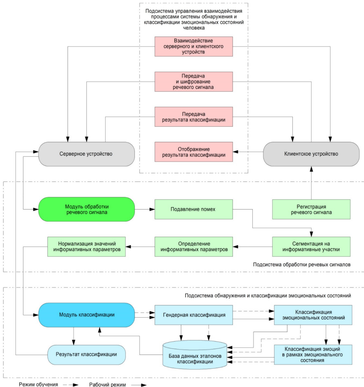
Рис. 1. Структура клиент-серверного решения системы обнаружения и классификации эмоциональных состояний человека по речевым сигналам
