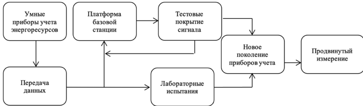
Рис. 1. Концепция интеллектуального счетчика электричества/газа/воды
