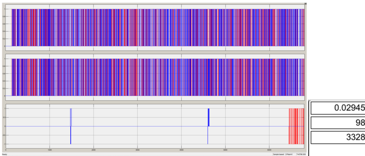
Рис. 9. Получение характеристик для «мягкого» декодирования сверточных кодов по алгоритму Витерби при отношении сигнал/шум, равное 2 дБ
