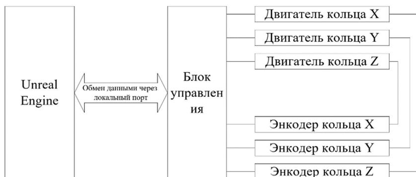
Рис. 5. Обобщенная структурная схема системы управления платформы
