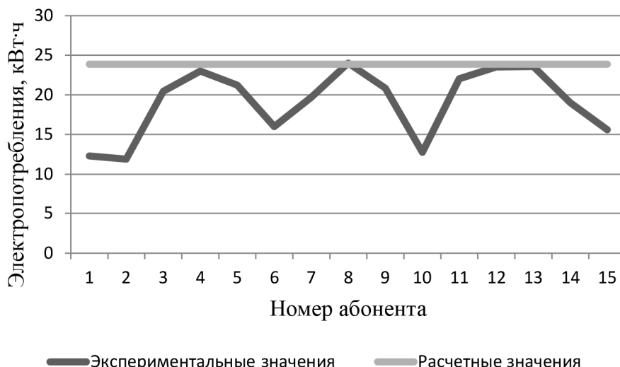
Рис. 5. Сравнение данных, полученных расчетным и экспериментальным путем для бытовых потребителей, питающихся от ТП-739 г. Душанбе
