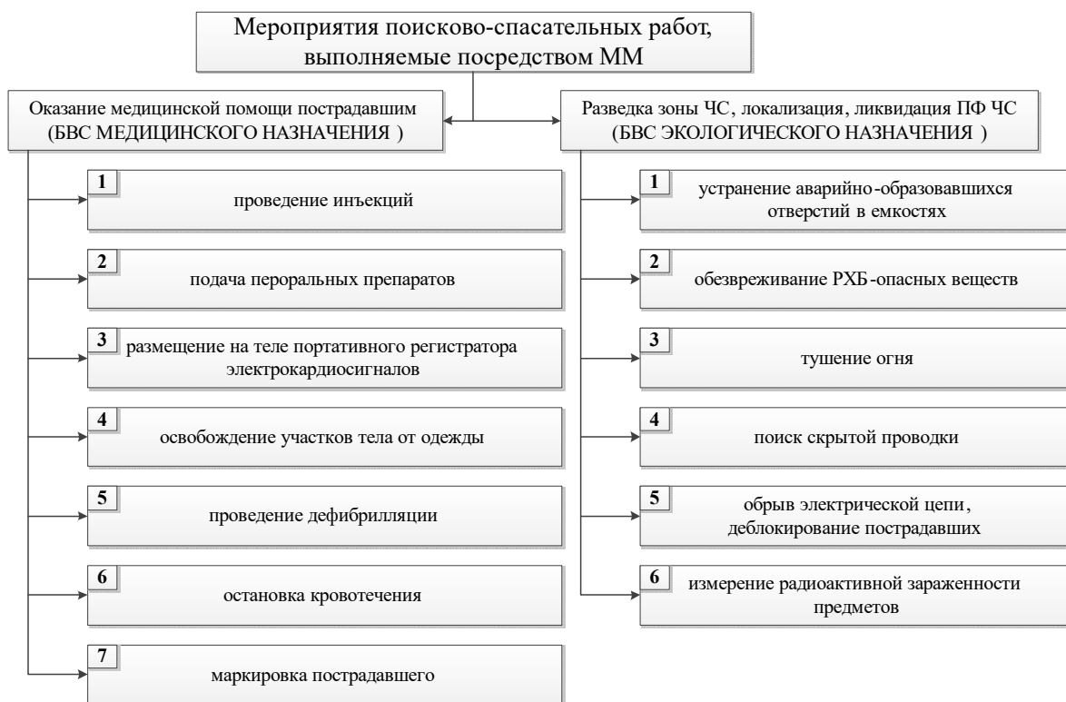
Рис. 3. Операции, выполняемые с помощью механического манипулятора
