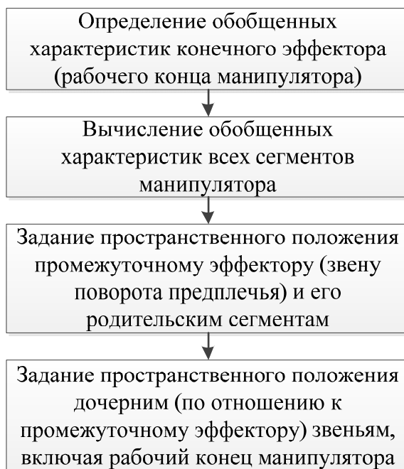
Рис. 7. Алгоритм управления механическим манипулятором
