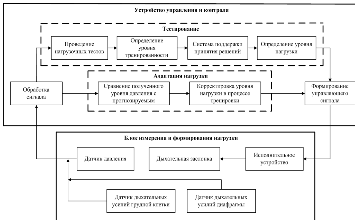
Рис. 1. Структура информационно-управляющего комплекса, воздействующего на дыхательную систему человека
