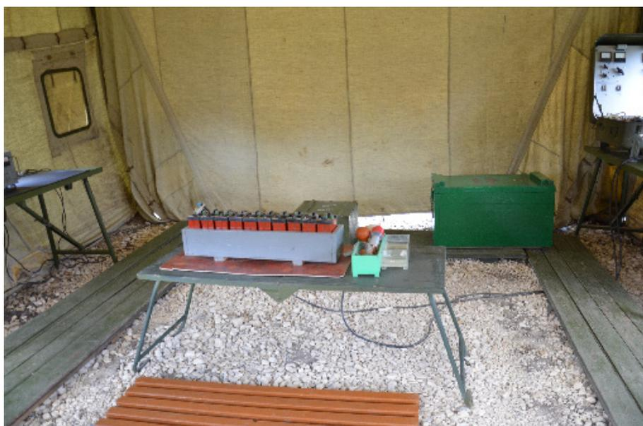
Рис. 1. Рабочее место для заливки и зарядки АКБ
