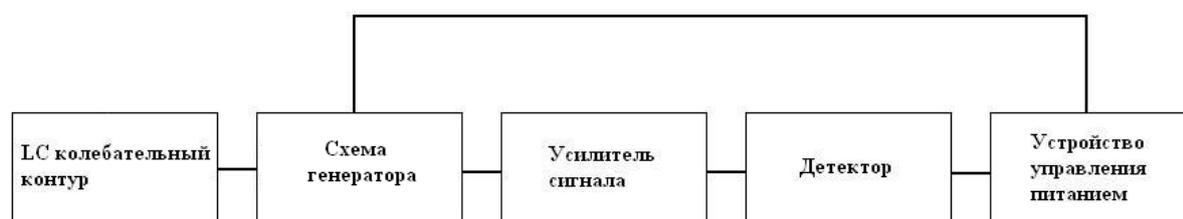
Рис. 12. Блок-схема генератора с обратной связью
