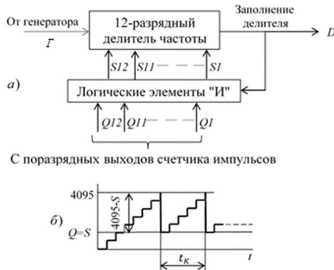
Рис. 6. Работа делителя частоты в режиме контроля:
