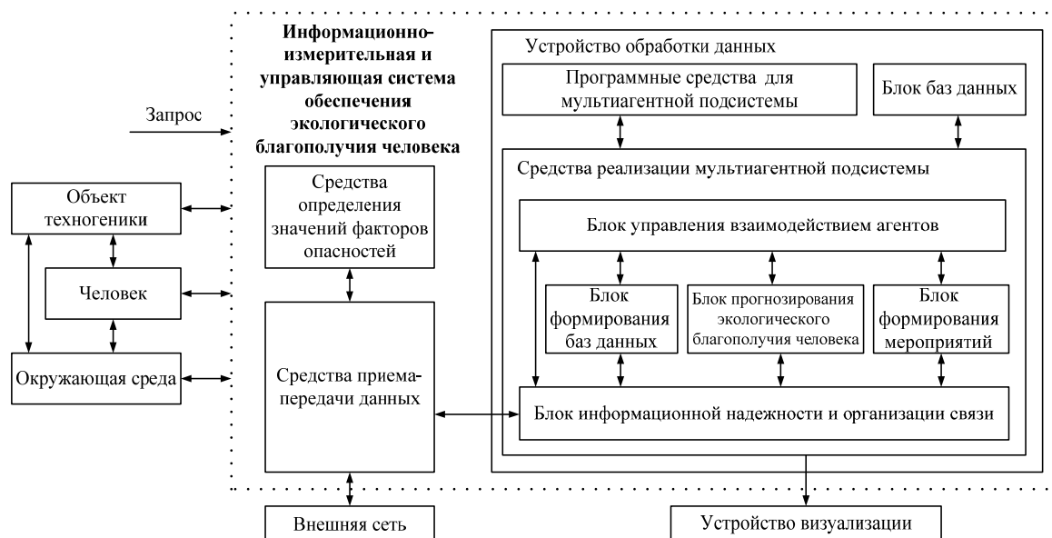
Рис. 1. Упрощенная схема информационно-измерительной и управляющей системы обеспечения экологического благополучия человека
