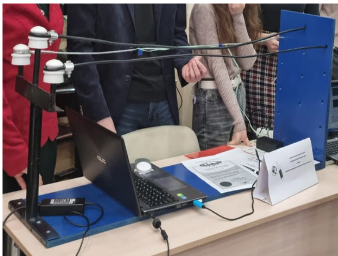
Рис. 1. Общий вид стенда-макета для исследования оперативных режимов работы ВЛ
