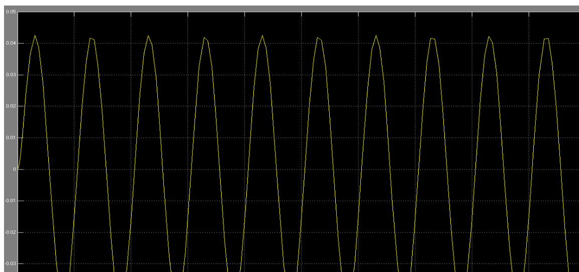
Рис. 6. Выходной ток трехэлементной схемы замещения с учетом влияния температуры
