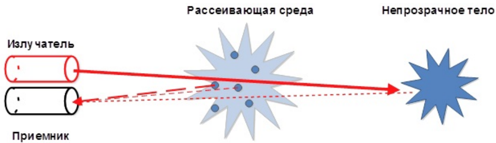
Рис. 1. Принцип действия лидара
