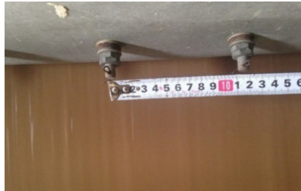
Рис. 12. Расстояние между секциями напорного ящика в сантиметрах
