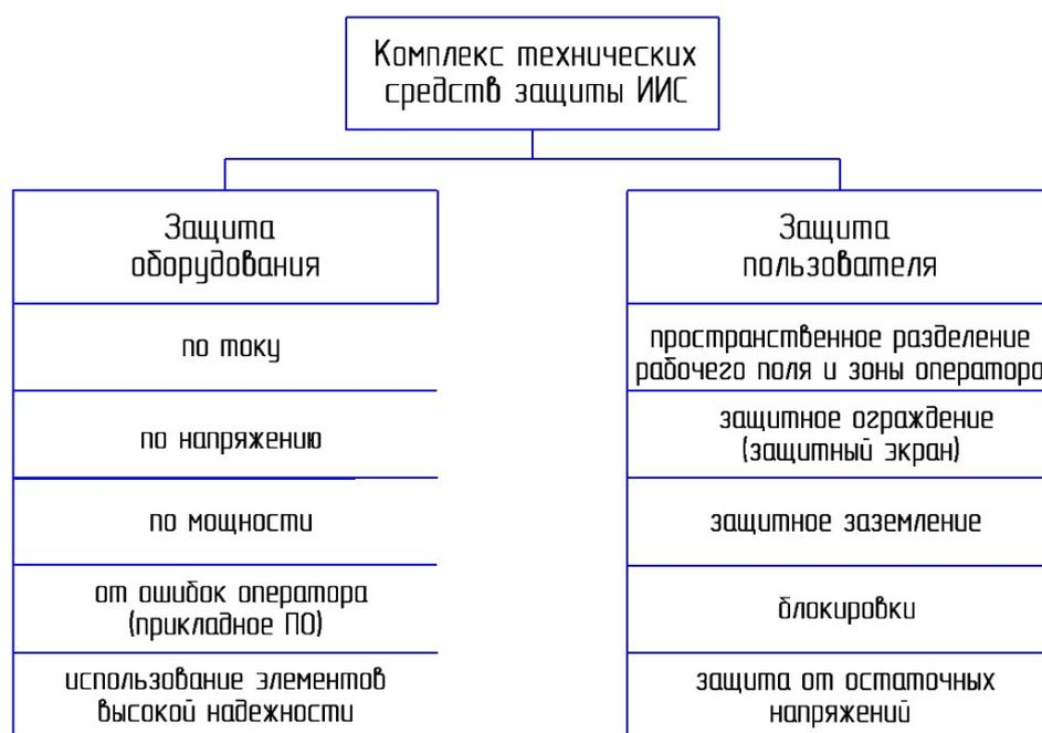
Рис. 1. Структура комплексной защиты ИИС поверки киловольтметров
