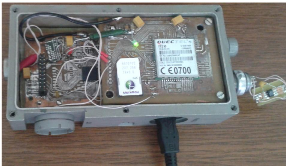
Рис. 2. Вид устройства со снятой крышкой
