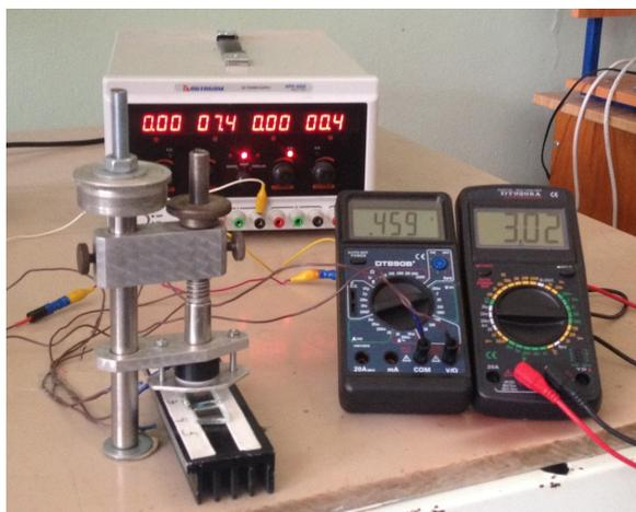
Рис. 3. Фотография четырехзондовой системы измерений
