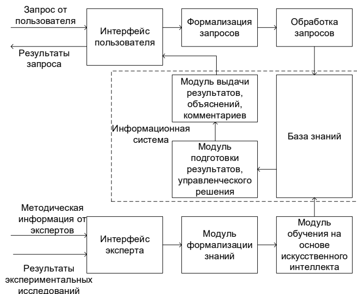
Рис. 1. Обобщенная структурная схема СППР для оценивания параметров надежности
