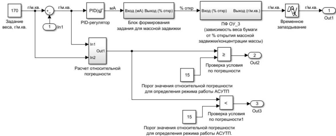
Рис. 6. Блок управления массовой задвижкой из рис. 5
