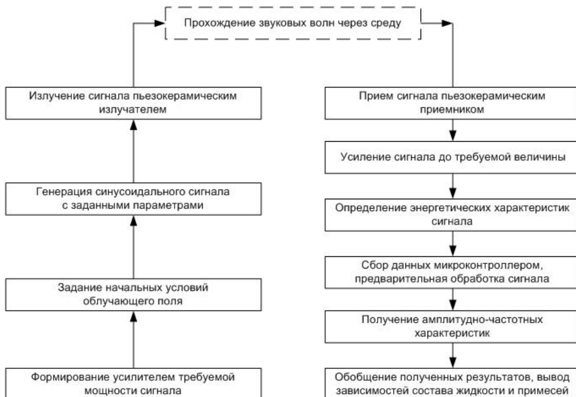
Рис. 3. Принципиальная схема обработки измерительного сигнала
